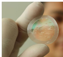
独自開発の圧倒的に高いCO 2 透過量を持つCO 2 分離ナノ膜
